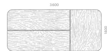
Echtholz 3-Schichtplatten: Die Maserung der rechten Tischplatte verläuft um 90° gedreht zu den anderen zwei Tischplatten.
