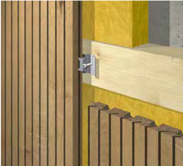
Detail vertikale Montage mit Montageclip
