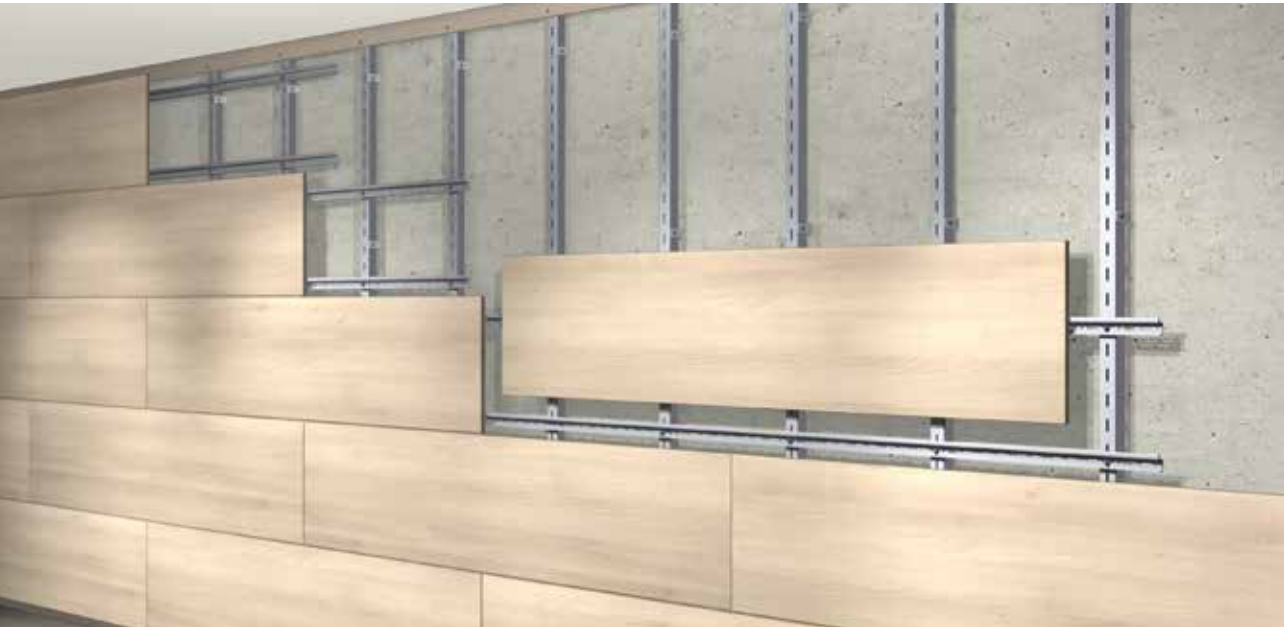
Horizontale Montage mit Feder
