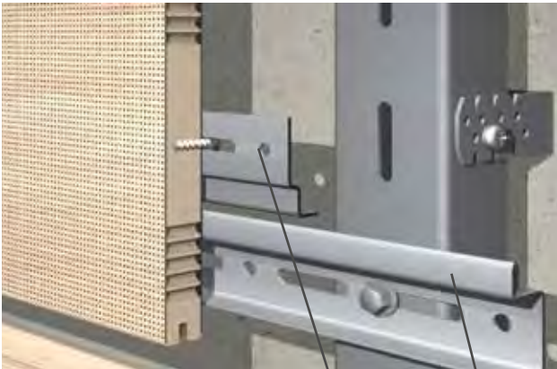
Detailansicht: horizontale Montage mit Feder
