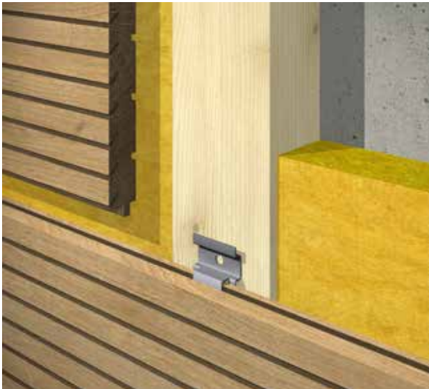
Detail horizontale Montage mit Montageclip
